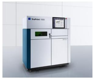
Dans le cas de la fabrication additive, la combinaison du laser et de la poudre métallique donne forme aux composants voulus. La TruPrint 1000 est une machine compacte pour la fabrication couche après couche de petits composants métalliques sur un lit de poudre.
